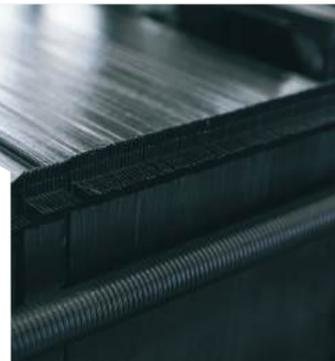
ВЫСОКОТЕХНОЛОГИЧНАЯ АНИЗОТРОПНАЯ СТАЛЬ / ШИХТОВКА STEP-LAP
